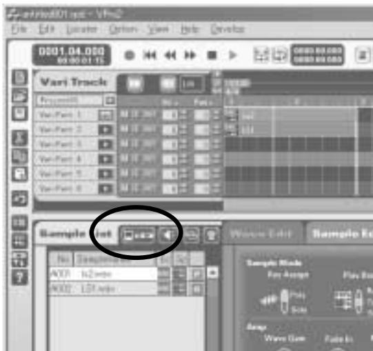
\* *El V-Producer es capaz de cargar archivos de ondas en formato Wave file (.WAV), formato archivo AIFF (.AIF), o en formato VariPhrase (.VPW).*
