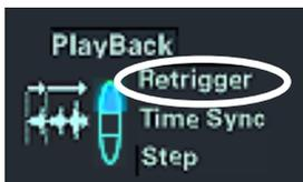
Si desea editar slices en la pantalla *groove scope*, vaya a la pantalla *Sample Edit* (p. 56) y ajuste el modo de reproducción de la muestra en “**Retrigger**” (p. 57). Si el modo de reproducción es algo que no sea “**Retrigger**,” al editar un evento, hará que se interrumpa el sonido o de otra manera que suene incorrectamente.
