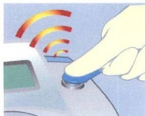
4. Mantenga apretado el **botón de calibración** con el **lector del botón** hasta que escuche el pitido. El botón debe tocar tanto el contacto central como los lados metálicos del lector de botones.
