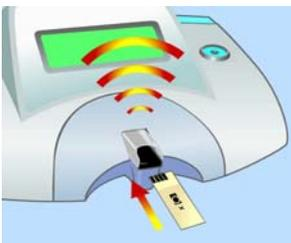
2. Inserte un sensor (con las barras negras mirando hacia arriba) completamente en el analizador. Cuando se inserta el sensor correctamente, el analizador emite un pitido y muestra el mensaje que aparece a la derecha.
