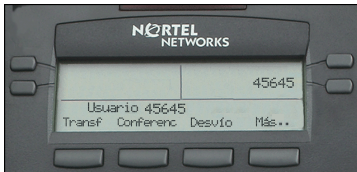
Figura 5: Conectado a un teléfono IP 2001 desde un teléfono IP 2002
