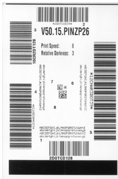
4. Consulte [Figura 26](#) y [Tabla 18](#). Inspeccione las etiquetas de prueba y determine cuál refleja la mejor calidad de impresión para su aplicación. Si tiene un verificador de códigos de barras, utilícelo para medir las barras y los espacios y para calcular el contraste de impresión. Si no tiene un verificador de códigos de barra, elija a ojo o con el escáner del sistema el ajuste de contraste óptimo analizando las etiquetas impresas en esta autopruueba.
