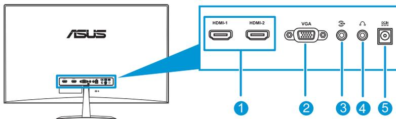
1. **Puerto HDMI:** este puerto permite realizar una conexión con un dispositivo compatible con HDMI.
