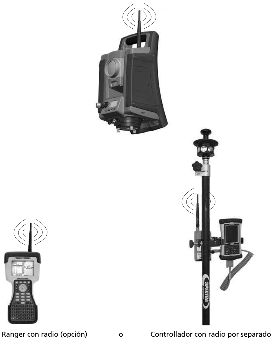
Figura 4.55 Controlador externo conectado a la estación total Spectra Precision FOCUS 30 utilizando la radio para las mediciones robóticas.
