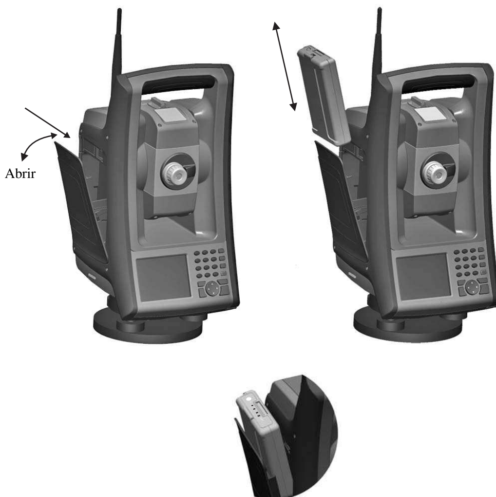
Figura 3.3 Cómo sacar y cambiar la batería interna
