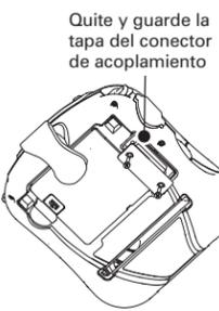
Quite y guarde la tapa del conector de acoplamiento. Cuando la impresora RW 420 está "acoplada", la base permite imprimir, recibir y transmitir datos, además de cargar las baterías. Para obtener más información, consulte la documentación de la Guía del usuario o la suministrada con la base.
