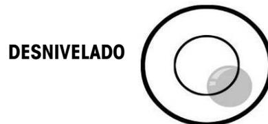
El indicador de nivel consiste en una burbuja y dos círculos. Centre la burbuja y la báscula quedará nivelada.
