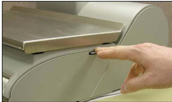
Retire la impresora mediante la pestaña verde que está en la impresora.
