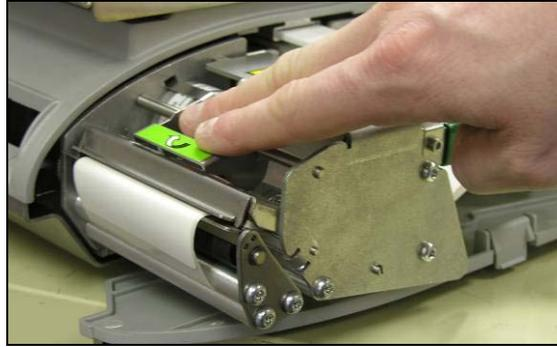
Cuando la impresora tenga las etiquetas instaladas correctamente, como se muestra, empuje la impresora nuevamente hacia su lugar y cierre la puerta.
