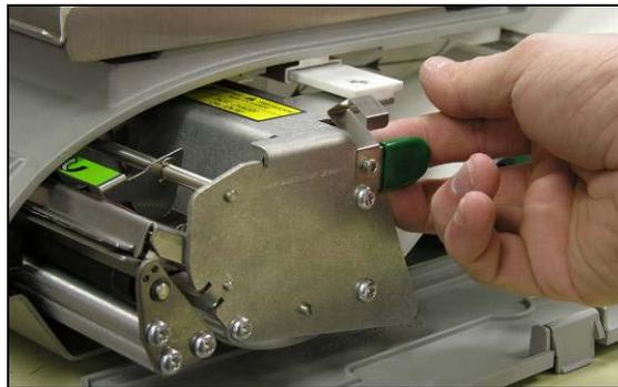
Desbloquee y levante la aldabilla para desbloquear y elevar la cabeza de impresión.
