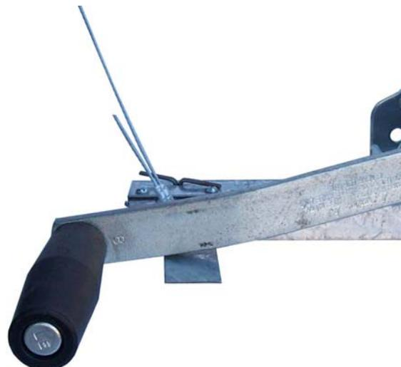
7. Enganchar el cable de acero en la ranura del brazo de la caída de cortina. Inmovilizar el extremo del cable a un punto fijo mediante un tornillo.
