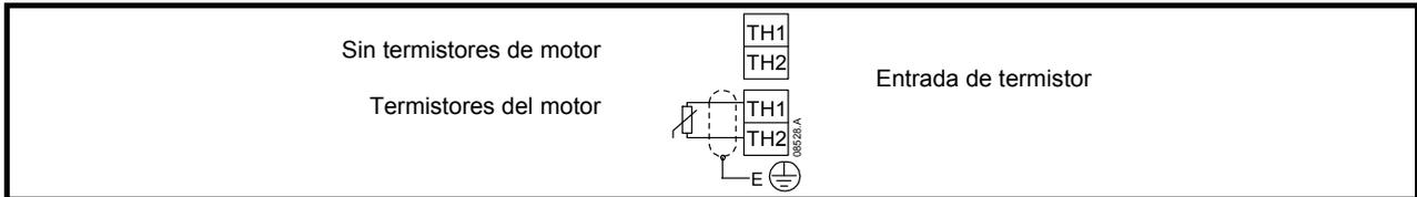
**NOTA** Si no se conecta al Digistart D3 ningún termistor los terminales de entrada de termistor TH1, TH2 se deben dejar en circuito abierto. Si los TH1, TH2 están en cortocircuito, el Digistart D3 disparará. Para el circuito del termistor se debe utilizar cable apantallado y debe estar aislado eléctricamente de tierra y de cualquier otra alimentación y circuitos de control.
