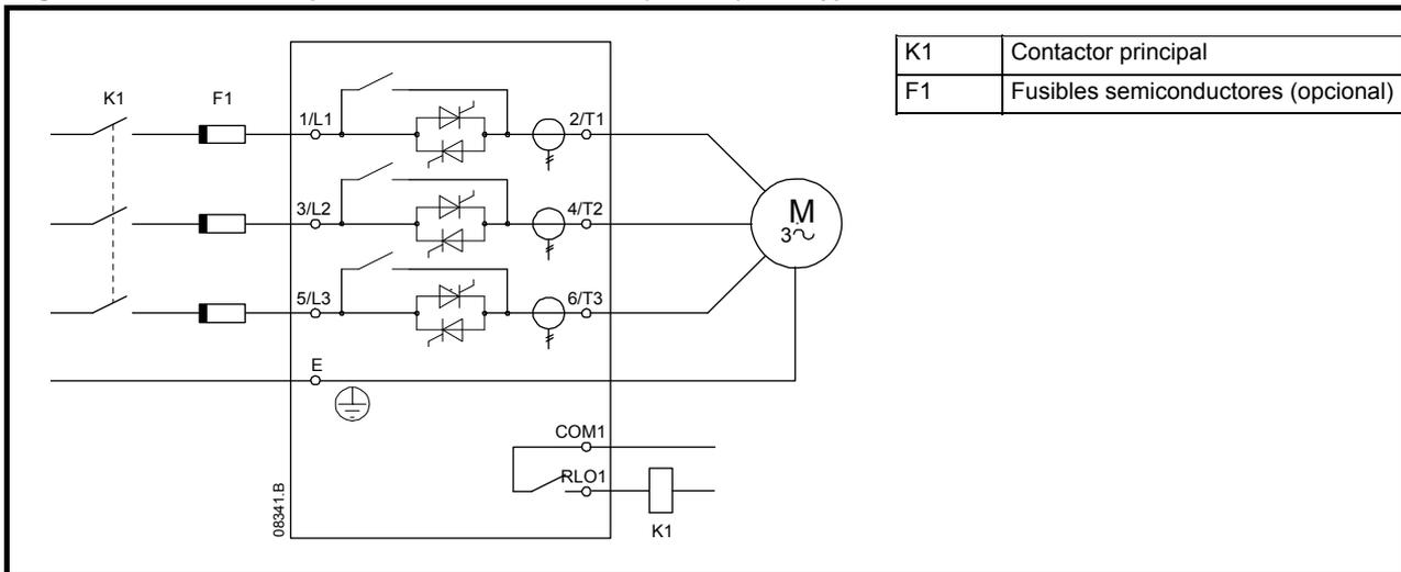
**NOTA** Interruptor principal es el ajuste predeterminado para el Pr **4A Acción relé A** COM1, RLO1.
