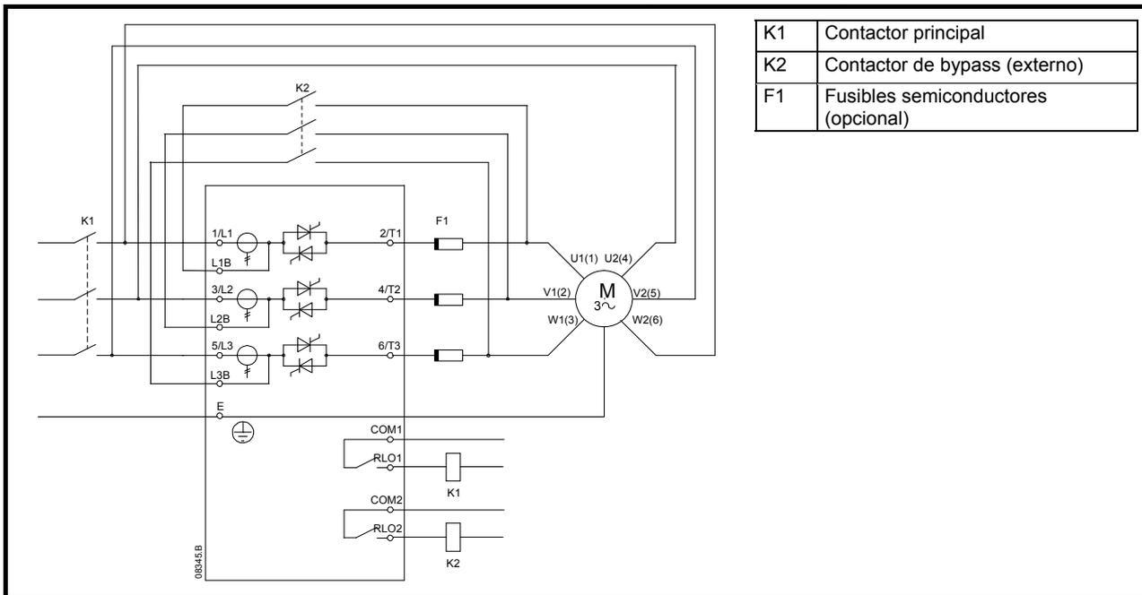
**NOTA** Los terminales del bypass en D3-1x-0255-N son T1B, T2B, T3B. Los terminales del bypass en D3-1x-0360-N a D3-16-1600-N son L1B, L2B, L3B.
