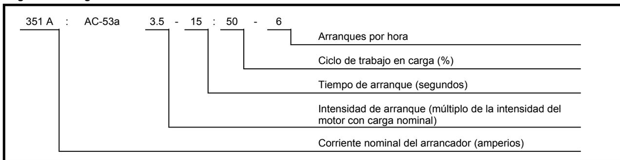
**Corriente nominal del arrancador:** La intensidad nominal de carga nominal del arrancador suave proporciona los parámetros detallados en las restantes secciones del código de utilización.
