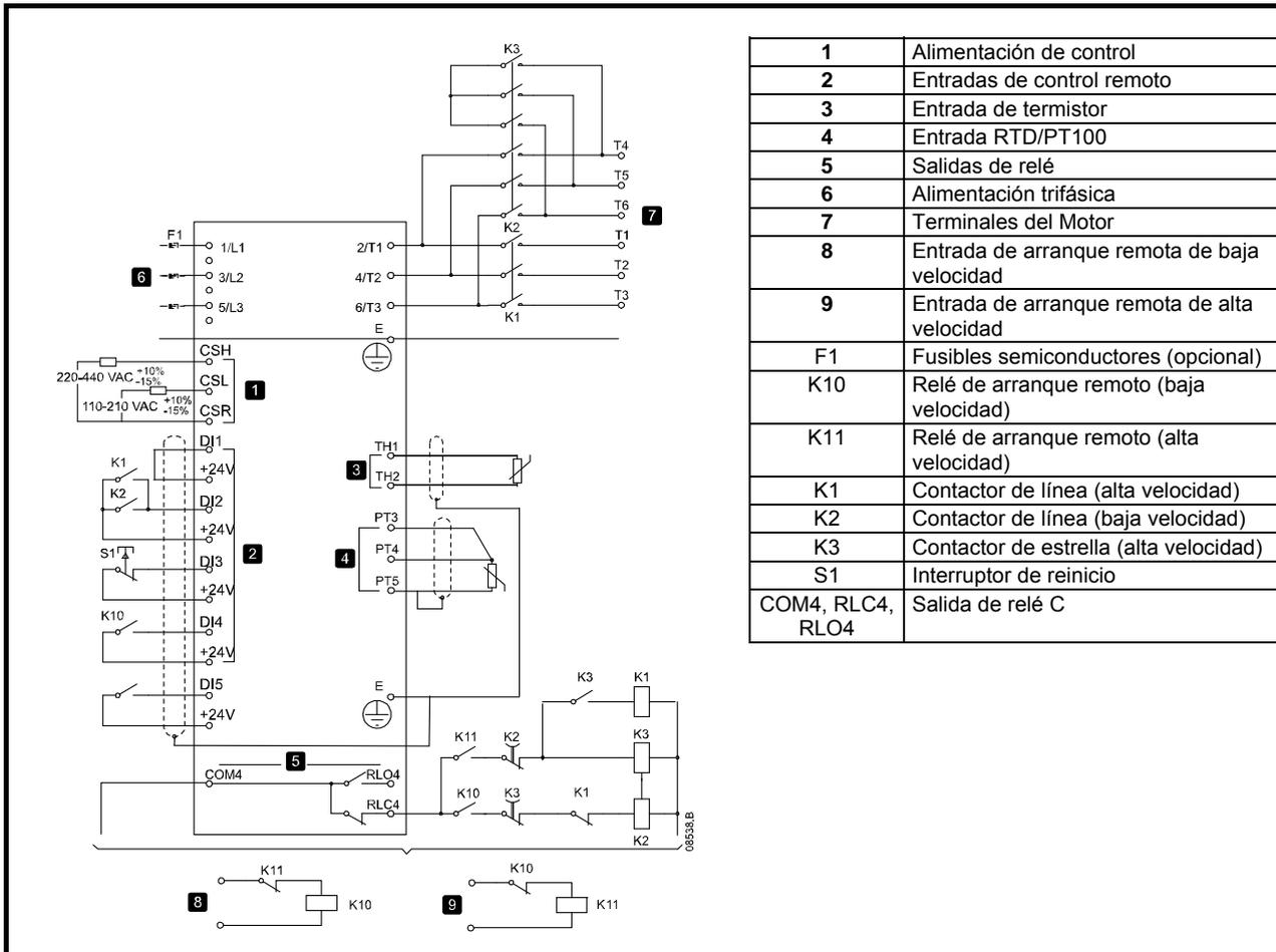
**NOTA** Los contactores K2 y K3 deben estar enclavados mecánicamente.
