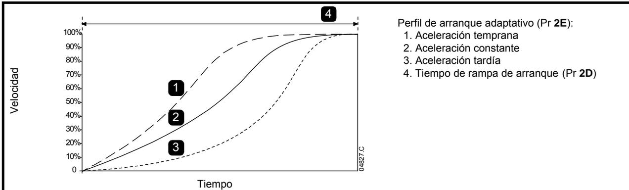
**NOTA** El Control Adaptativo controlará la carga según el perfil programado. La intensidad de arranque variará según el perfil de aceleración y el tiempo de arranque seleccionados.
