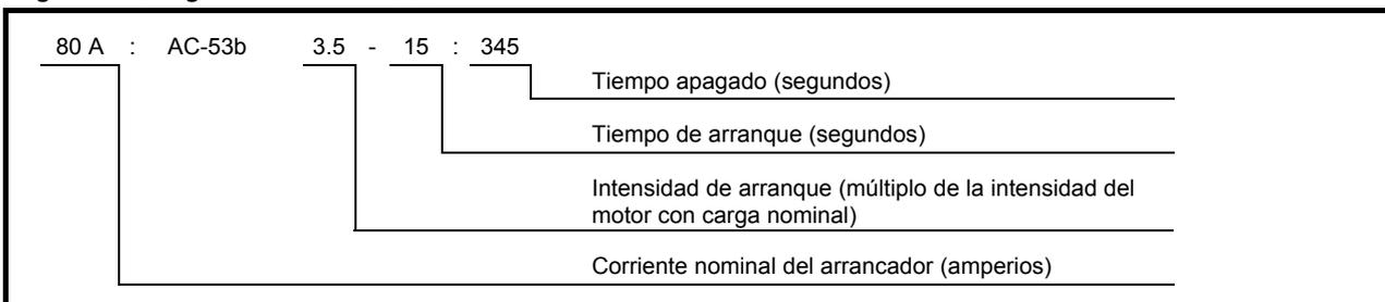
**Corriente nominal del arrancador:** La intensidad nominal de carga nominal del arrancador suave proporciona los parámetros detallados en las restantes secciones del código de utilización.
