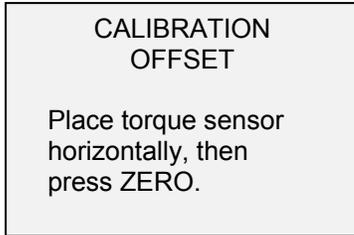
5. Coloque el instrumento sobre una superficie nivelada y libre de vibraciones, y presione **ZERO**. El instrumento calculará las desviaciones internas, y aparecerá la siguiente pantalla:
