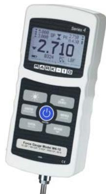
Le agradecemos haber adquirido un dinamómetro digital Mark-10 Serie 4, diseñado para ensayos de fuerza de tracción y compresión desde 0,12 lb hasta 500 lb (0,5 N a 2500 N) como fondo de escala. El Serie 4 es un componente esencial de cualquier sistema de ensayos de fuerza, y por lo general comprende también un banco de ensayos, mordazas y software de recopilación de datos.
