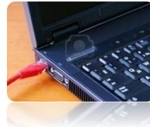
Es el puerto u orificio de la CPU al cual se conecta el cable UTP.
