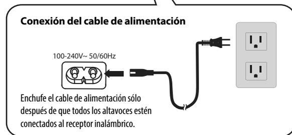
Enchufe el cable de alimentación sólo después de que todos los altavoces estén conectados al receptor inalámbrico.
