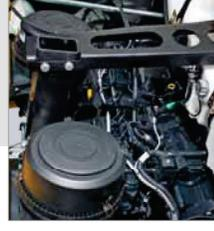
**Filtros de aire separados para motor y compresor**
