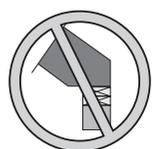
No permita que una parte excesiva de los cortes del asiento quede en voladizo en las vigas LVL GP Lam de la cara interior del miembro de soporte.
