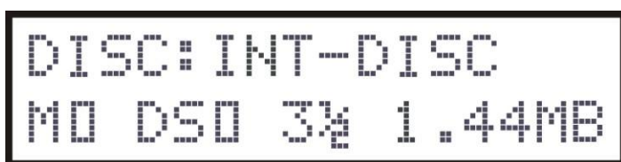
Muestra un Disco interno montado
