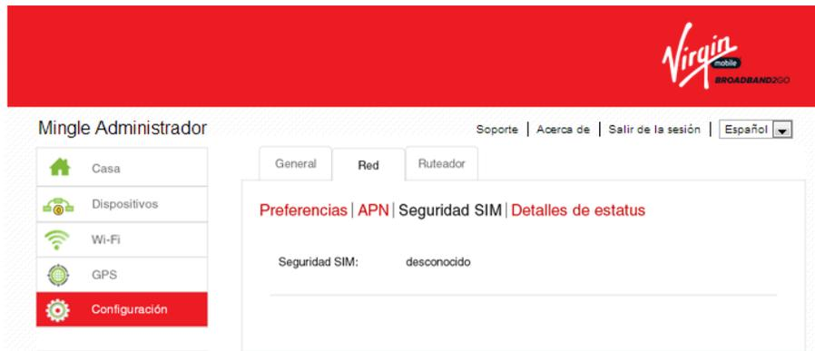
3. Si la tarjeta SIM tiene seguridad habilitada, la seguridad de SIM aparece como Activa. Haga clic en **Inhabilitar** para desactivar la seguridad SIM.
