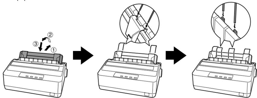
**3** Retire la cubierta de la impresora y la unidad tensora del papel.
