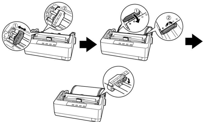
Vuelva a colocar la guía de papel y la cubierta de la impresora.
