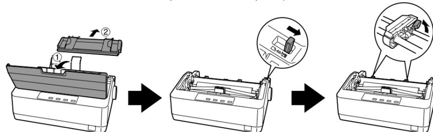
Deslice la rueda dentada izquierda a la marca ∇ y trábela. Deslice la rueda dentada derecha a la orilla del papel. Cierre las cubiertas de las ruedas dentadas. Bloquee la rueda dentada derecha.
