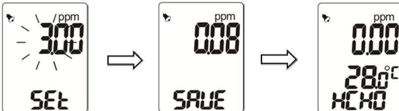
**Nota:** El icono de la campana se muestra en la esquina superior izquierda de la pantalla LCD cuando la alarma está activada. Presione momentáneamente el botón **POWER** para armar o desarmar la alarma.
