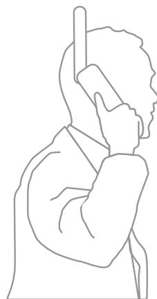
Sitúese en el exterior a cielo descubierto y con la antena del teléfono orientada hacia arriba. Debe existir una vía despejada entre la antena del teléfono y el satélite.
