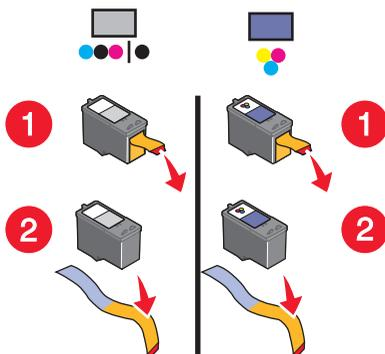
**Advertencia:** No toque el área de contacto dorada de la parte trasera ni los inyectores de metal de la parte inferior de los cartuchos.
