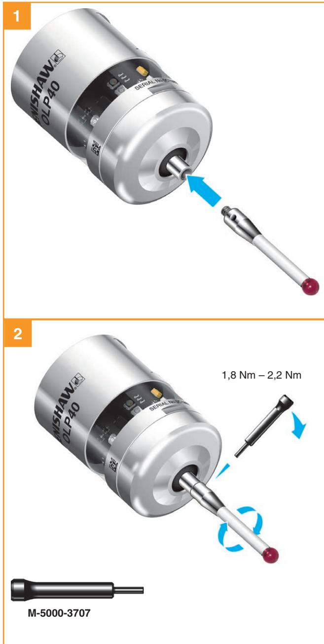
**Junta de rotura del palpador**
