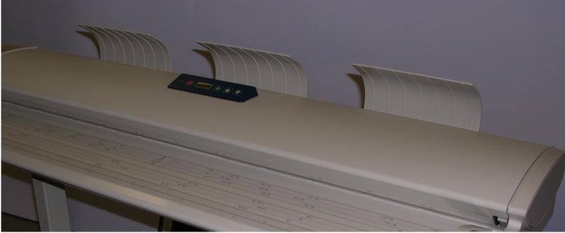
Coloque cada uno de los tres deflectores de salida de papel en las ranuras correspondientes ubicadas en el borde superior trasero del escáner. Asegúrese de que se introduzcan correctamente en las ranuras y de que no bloqueen la apertura de salida del documento; normalmente esto no se tiene en cuenta al instalarlos.
