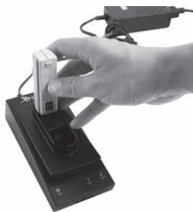
Figura 14: Caricabatterie con batterie.
