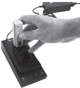
Figura 14: cargador con baterías.
