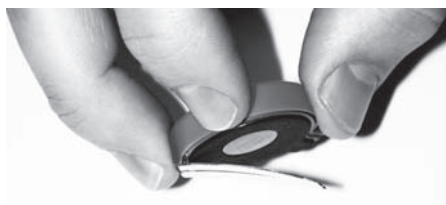
Figura 8: Modo corretto di reggere il microfono-antenna.
