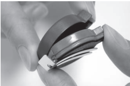
Figura 6. Adaptación de la caperuza de color del auricular.
