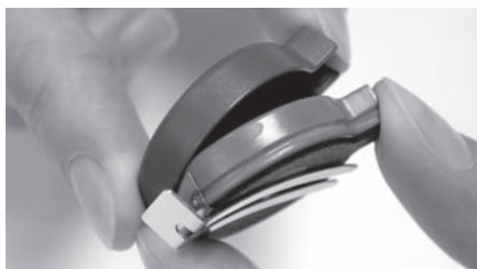
Figura 6: Montaggio del coperchietto colorato del microfono-antenna.
