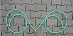
En combinación con 2 unidades de manguera de distribución triple se pueden conectar hasta 6 tubos de aspiración al Vakumobil.
