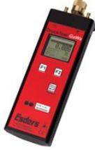
DruckTest GaWa Bateria 2/25 bar campo de medición 0 hasta 2 bar y 0 hasta 25 bar
