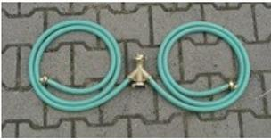
Conexión de hasta 3 tubos de aspiración mediante acoples bayoneta
