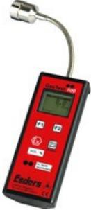
Aparato medidor de gas resistente y preciso, en caja de aluminio, con sensor en el cuello de cisne. Indicación de la concentración de gas con una resolución de 0,1 Vol.%. Campo de medición 0 hasta 100 Vol.% metano
