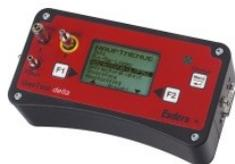
Aparato de medición para la instalación interior de gas
