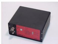
Mediante una tecla se pueden seleccionar y liberar 2 gases patrón (10ppm & 2,2% CH<sub>4</sub>).
