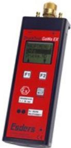
DruckTest GaWa EX Batería 2/25 bar campo de medición 0-2 bar y 0-25 bar
