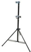
Trípode con dos pinzas de sujeción para el montaje del tubo vertical de comprobación
