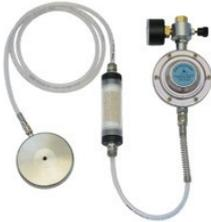
Utilización en combinación con botes de gas a presión; con acondicionamiento del gas patrón y adaptador de sonda. Regulador de toma para la conexión directa a botes de gas a presión. Limitación de presión y de caudal para la alimentación exacta de gas patrón. La operación requiere botes de gas patrón a presión de 10 ppm de metano en aire sintético.
