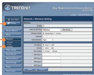
13. Haga clic en Site Survey (Inspección del sitio). Seleccione su red inalámbrica. Si la encriptación está activa, seleccione el tipo de Autenticación apropiado, introduzca la Pre-Shared Key (clave inicial compartida y luego haga clic en Apply (Aplicar). (Ejemplo con WPA2-PSK. Si su red inalámbrica no es compatible con WPA, seleccione una red abierta o compartida. Póngase en contacto con su administrador de red para más información).
