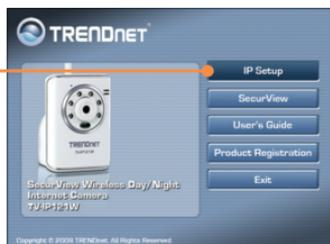
2. Siga las instrucciones del IPSetup Setup Wizard (Configurar IP) y luego haga clic en Close.
