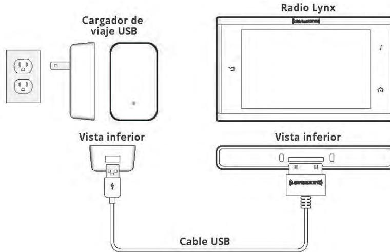
También es posible cargar Lynx a través de un puerto USB en cualquier computadora. Se recomienda apagar Lynx o ponerlo en cualquier modo que no sea reproducción de audio cuando carga a partir de una computadora; de lo contrario, la batería no se carga. Conecte el extremo más grande del cable USB en la parte inferior de Lynx y el extremo más pequeño en el puerto USB de la computadora.
