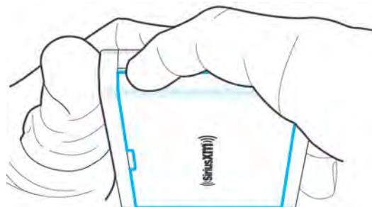
2. Si la batería de Lynx está instalada, retire la batería.
