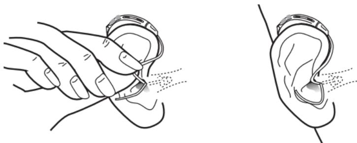
1. Sujete el tubo fino desde el punto de conexión con la cápsula e inserte suavemente el la cápsula en el canal auditivo. Debe quedar al nivel de la cabeza y no sobresalir.
