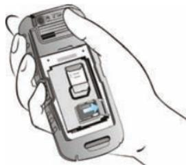
5. Vuelva a colocar en su sitio la batería y la carcasa. Apriete los tornillos de la tapa de la batería en el sentido de las agujas del reloj para fijarla.
