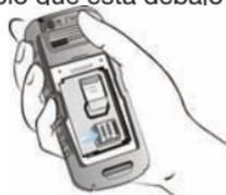
4. Coloque la tarjeta SD en la ranura correspondiente y cierre la tapa plateada.
