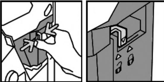
3. Sujete el contenedor y mueva la palanca hacia la derecha a la posición de desbloqueo.
