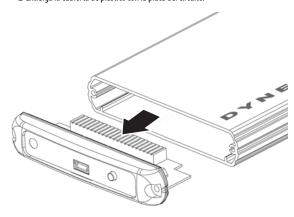
3 Enchufe el conector de datos de la unidad de disco duro en el conector correspondiente en la placa del circuito de la caja.
