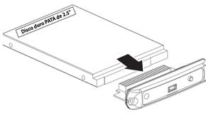
4 Coloque el disco duro con la cubierta de plástico en la caja de aluminio y asegúrela con los dos tornillos que retiró anteriormente.
