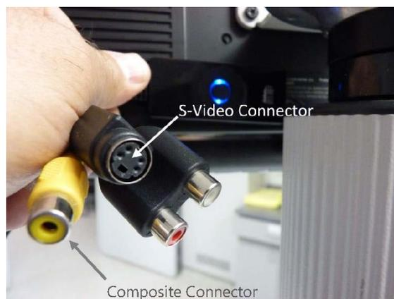
Figura 33. Conectores del dispositivo de captura de vídeo AV-200
