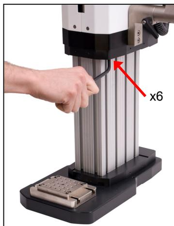
4. Coloque el banco de pruebas en sentido vertical y vuelva a instalar las cubiertas de chapa, como se muestra en la siguiente imagen:
