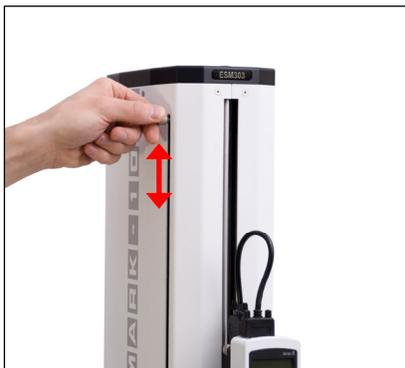
Los interruptores de final de carrera permiten al operador fijar una ubicación a lo largo de la columna en la cual la cruceta dejará de moverse. Los interruptores de final de carrera están situados en el lado izquierdo de la columna del banco de prueba, como se muestra en la imagen de la izquierda. Ajuste sus posiciones al aflojar los tornillos de mariposa, recolóquelos y vuelva a apretar los tornillos de mariposa.
