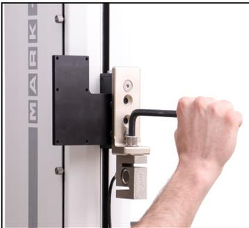
5. Monte el indicador utilizando los cuatro tornillos de mariposa suministrados y enchufe el conector Plug & Test™ en el indicador. Oriente la carcasa del indicador de tal manera que el conector apunte hacia abajo. Consulte la guía de usuario del indicador para obtener más detalles.
