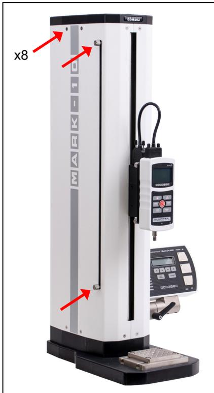
3. La placa de soporte de los componentes electrónicos contiene la mayoría de los componentes electrónicos del banco de pruebas, y debe retirarse para acceder al área requerida. En primer lugar, retire los 6 tornillos, que se identifican en la imagen a continuación. **No** separe todavía la placa de la columna, ya que su retirada requiere pasos adicionales.
