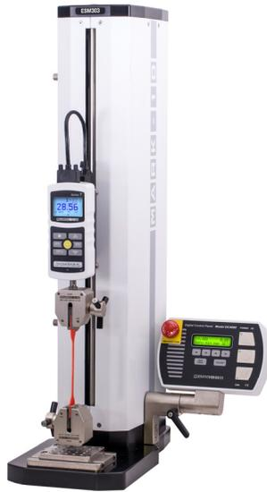
Gracias por comprar el banco de pruebas de fuerza Mark-10 ESM303, diseñado para producir hasta 300 lbF (1,5 kN) de fuerza de tracción y compresión. El ESM303 es un componente esencial de un sistema de pruebas de fuerza que suele comprender también un medidor de fuerza, o una célula de carga con indicador y agarres.
