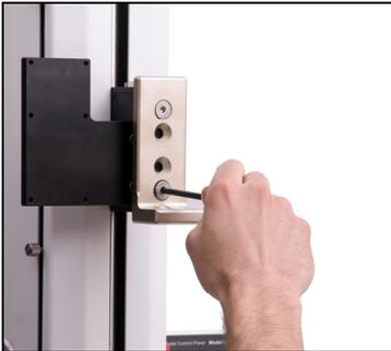
4. Monte la célula de carga en el soporte en L utilizando los herrajes incluidos.
