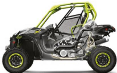
MOTOR ROTAX 1000R DE 121 CV<sup>1</sup> CON SOBREALIMENTACIÓN
