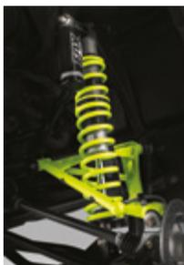
AMORTIGUADORES TRASEROS FOX 2.5 PODIUM RC2 DE GAS A ALTA PRESIÓN CON PUNTO DE CRUCE EN MUELLE Y CONTROL DE COMPRESIÓN DE FINAL DE RECORRIDO
