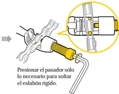
Cuando presione sobre el pasador, empuje hacia abajo la parte superior de la cadena para mantenerla completamente engranada en la cuna del troncha cadenas. Asegúrese de que el pasador de presión del troncha cadenas se encuentra centrado sobre el pasador de la cadena para evitar dañar el troncha cadenas o la cadena.
