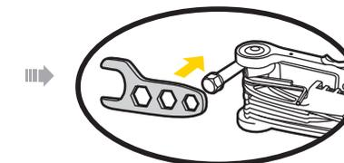
Introduzca la llave Allen de 8mm en la hexagonal de 8mm de la mini llave de pedal. Despliegue las herramientas como se muestra para hacer más palanca.
