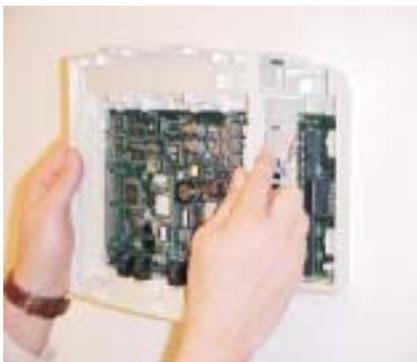
**Figura 17. Instalación del Módulo de Despliegue**
