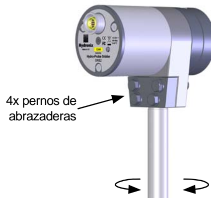
Figure 14: Ajuste del ángulo de la cabeza del sensor
