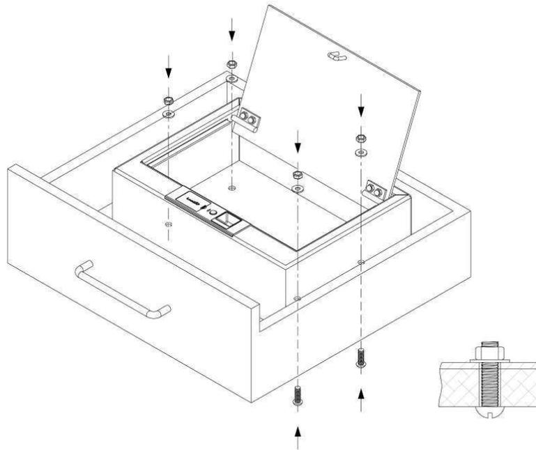
2. En una superficie sólida donde usted no puede tener acceso e ambos lados (suelo de escritorio, piso concreto, etc.), utilice los tornillos/cerrosjos apropiados, las arandelas, y las anclas si necesario para esa superficie. Vea el ejemplo abajo.
