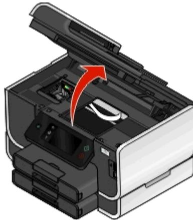
**Nota:** El cabezal de impresión se mueve a la posición de instalación del cartucho.
