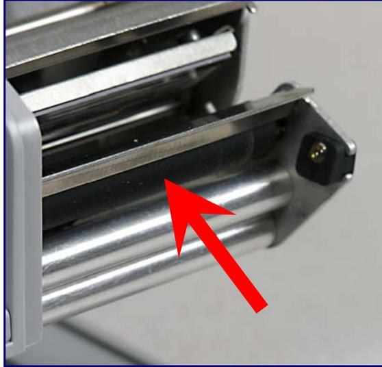
Cuando se saca la impresora y antes de instalar el nuevo rollo de etiquetas, gire las etiquetas. Después use la pluma de limpieza para eliminar la acumulación.
