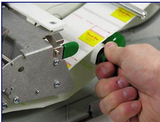
Presione la aldabilla de la cabeza de impresión hasta que se bloquee.
