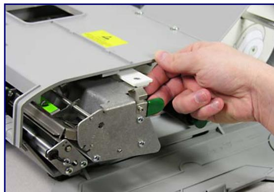
Desbloquee y levante la aldabilla para desbloquear y elevar la cabeza de impresión.
