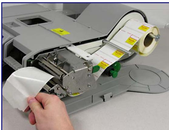
Empuje con cuidado la perilla verde para bloquear el revestimiento y enseguida gire el rodillo hacia la derecha para reducir la holgura del revestimiento.
