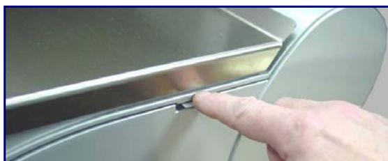
Retire la impresora mediante la pestaña verde que está en la impresora.
