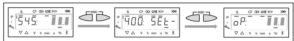
**23. Comprobar el funcionamiento al arranque**
