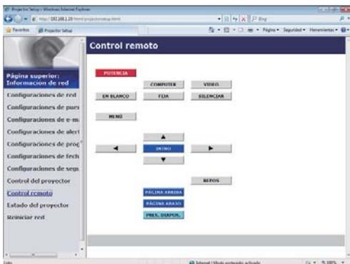
Usted puede utilizar su navegador de la Web para controlar el proyector. Las funciones del control remoto incluido se asignan a la pantalla Control remoto Web.
