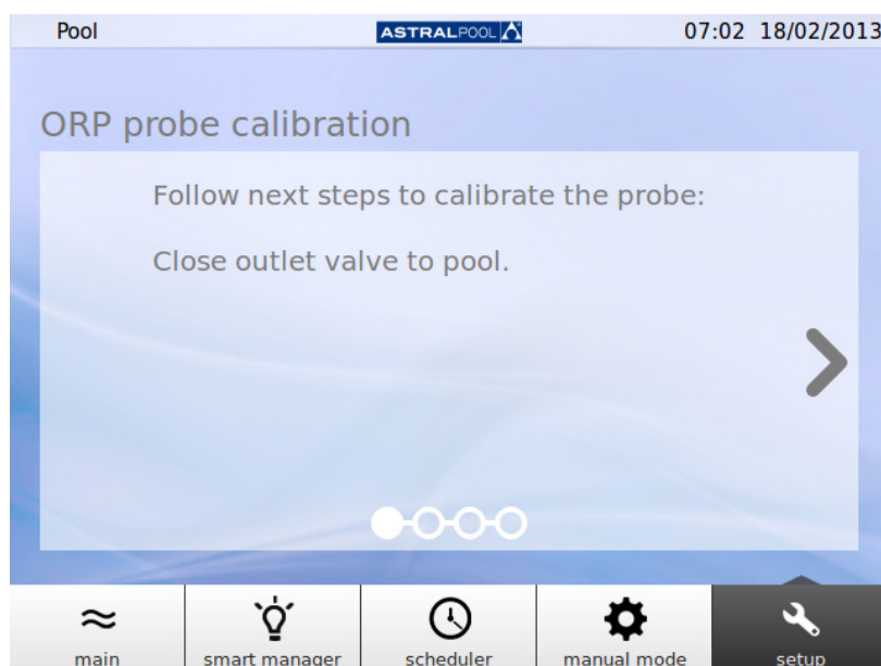
Figura 27: Cierre la válvula de salida a la piscina
