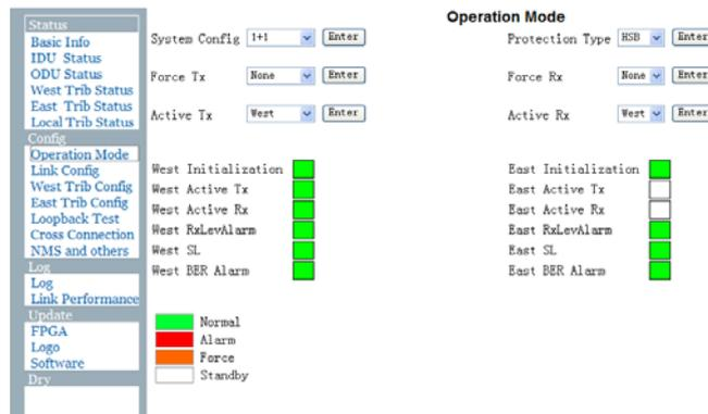
Elija '1+1' en System Config, y elija 'HSB' en tipo de protección. Elija 'None' para ambos, TX forzado, y Rx forzado [configuración manual].
