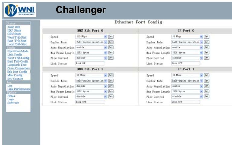
En esta página, el operador puede modificar las configuraciones de ambos puertos, Ethernet NMS, y de datos Ethernet del Usuario..
