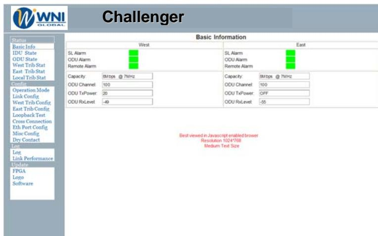
Muestra la información básica del sistema (capacidad, ancho de banda, canal de frecuencia, potencia de Tx & nivel de Rx) y alarmas comunes. Si hubiera una SL (Sync loss, pérdida de sincronización), las alarmas ODU y RA (Alarma remota), la indicación correspondiente reportará en rojo.
