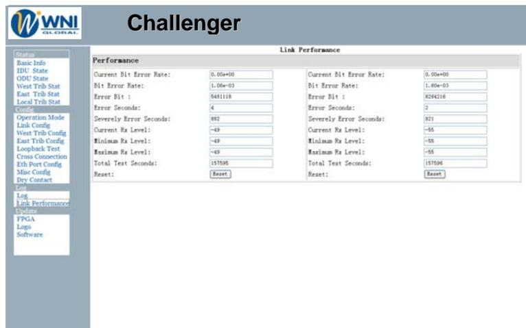
El operador puede monitorear el comportamiento del enlace, como por ejemplo, el valor actual de la tasa de error [BER], Bits con errores, segundos con errores, segundos con errores severos, Nivel actual de la Señal de Rx, Nivel mínimo de la señal de recepción, [durante el tiempo que dure la prueba] Nivel máximo de la señal de recepción [durante el tiempo que dure la prueba], número total
