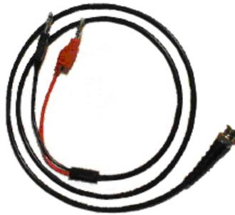
Figura 4.24 Cable para el alineamiento de la antena
