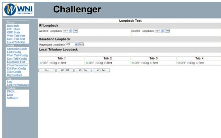
Las pruebas de bucle son utilizadas durante la instalación del equipo, para la localización de fallas, para determinar la confiabilidad del enlace, etc. Las siguientes pruebas de bucle están disponibles:
