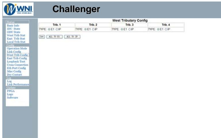
Hay **dos** tipos: E1 and IP. Cuando se configura un tributario para servicio IP, los 2 Mbps son utilizados para transmisión de VLAN transparente, y no aceptará pruebas de bucle [loopback]. Por otro lado, la IDU reunirá todos los tributarios con servicio IP y los juntará en un canal IP, y ofrecerá transmisión IP vía puertos de datos Ethernet.
