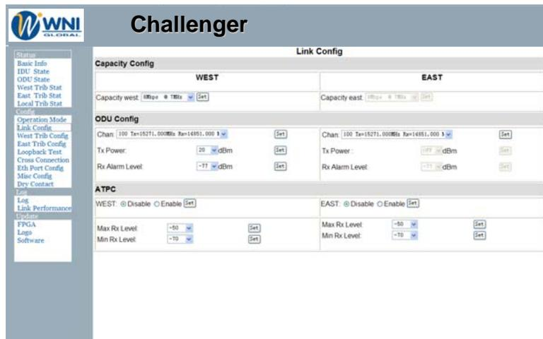
En esta página, el operador puede configurar la capacidad, canal de frecuencia de la ODU, potencia de Tx y nivel de umbral de Rx que activa la alarma.
