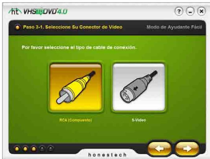
\*Los cables tipo S-Video transmiten los videos con mayor calidad que los cables comunes RCA (Compuestos) pero, contra lo que se piensa comúnmente, no transmiten las señales de audio.
