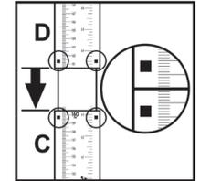
4. Deslice uno de los dos estabilizadores blancos en el soporte, luego el brazo de medición azul y luego deslice el segundo estabilizador blanco por encima (vea la ilustración 4). Coloque los estabilizadores de modo que queden libres de las uniones de las partes verticales.
