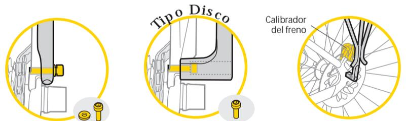
1. Al instalar el Portaequipajes comprobar que los tornillos no interfieran en el freno, la cadena y otras piezas del mecanismo antes de que estén completamente apretados. Apretar todos los tornillos firmemente a 6-8 Nm ( 53-69 in-ibs ) antes de cargar el Portaequipajes.
