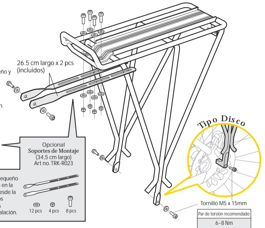
1. Una los soportes de montaje a la parte delantera de su One Fits Rear Rack (Transportín trasero) como se señala. No ajustarlo por completo en este momento.
