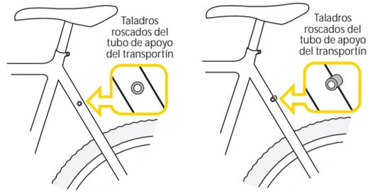
Este trasportín trasero está diseñado para adaptarlo a bicicletas a través del taladro roscado provisto en el tubo de apoyo del sillín. Los soportes de montaje del trasportín están diseñados para adaptarse a una gran variedad de bicicletas, desde ruedas de 26" x 14,5" de bastidor a ruedas de 700C x 63 cm de bastidor.
