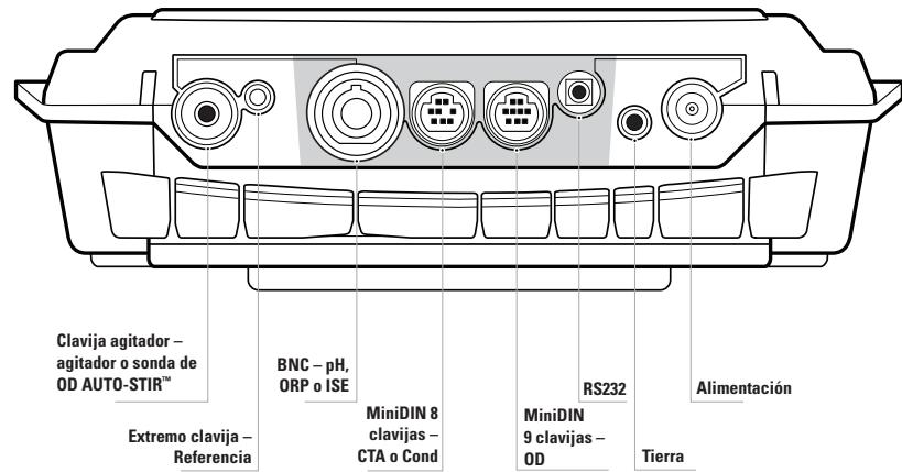
Todos los conectores del medidor de mesa 5-Star se ilustran arriba. Todos los conectores del medidor 5-Star Plus portátil se destacan en color gris.
