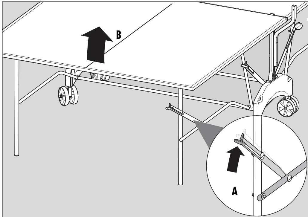
**D** Drücken Sie den Hebel der Standsicherung nach oben und heben Sie die Plattenhälfte an. Behalten Sie in der Anfangsphase des Hochklappens den Druck bei.
